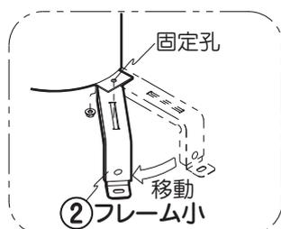
ポンプ本体の固定箇所が2個の場合や3個の場合は取付しないフレームができますが、外さないでそのまま任意の場所に配置してください。
