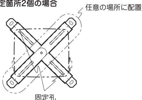
4. 水平な場所に組み立てた架台を置き、アンカーボルトを打ち込む場所をマークします。アンカーボルトを打ち込んだら架台と固定してください。
