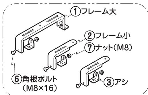
2. ①フレーム大と②フレーム小を⑥角根ボルト(M8×16)と⑦ナット(M8)で仮止めします。再度③アシの高さを調整し架台を水平にし⑦ナット(M8)を締め付けます。
